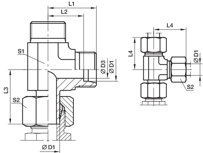
В сборе с гайкой и прогрессивным кольцом для подключения.
